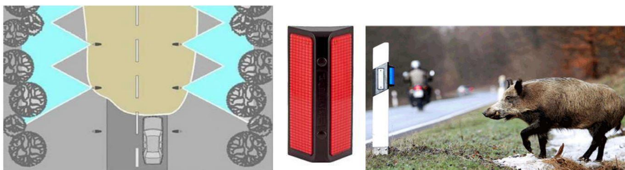
Figura 5-5 Esempio di catarifrangenti per abbassare la probabilità di attraversamento della fauna selvatica.
